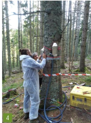
Photo > [4] Installation de capteurs de flux de sève, nouvelle parcelle JP © Nolwenn Lesparre
