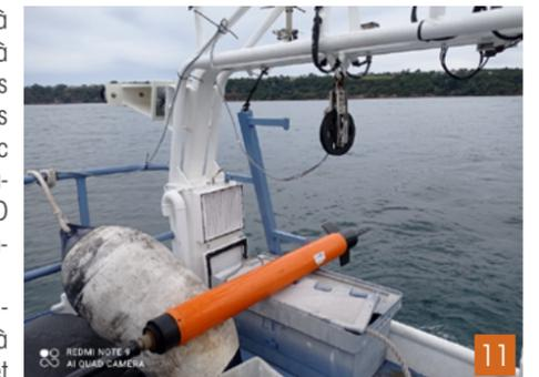
Photos > Capteurs magnétiques testés sur la campagne DETEX1.
