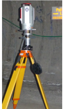
LiDAR longue-portée Riegl VMZ2000 en acquisition dans les Mines de Potasse d'Alsace. Crédits : G. Modeste & F. Masson
