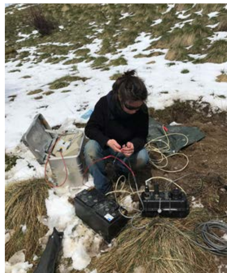
Installation d'un réseau de 3 sismomètres sur le mouvement de terrain par Floriane Provost (IPGS).
