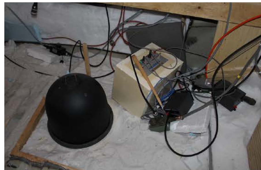
Sismomètre Trillium 240 avec sa protection thermique
