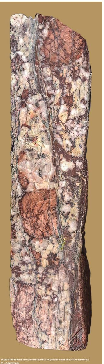
Le granite de Soultz: la roche réservoir du site géothermique de Soultz-sous-Forêts. © J. Schmittbuhl
