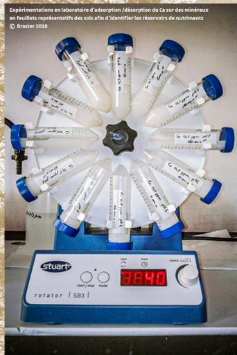
Expérimentations en laboratoire d'adsorption/désorption du Ca sur des minéraux en facilités représentatives des sols afin d'identifier les réservoirs de nutriments © Brazier 2018
