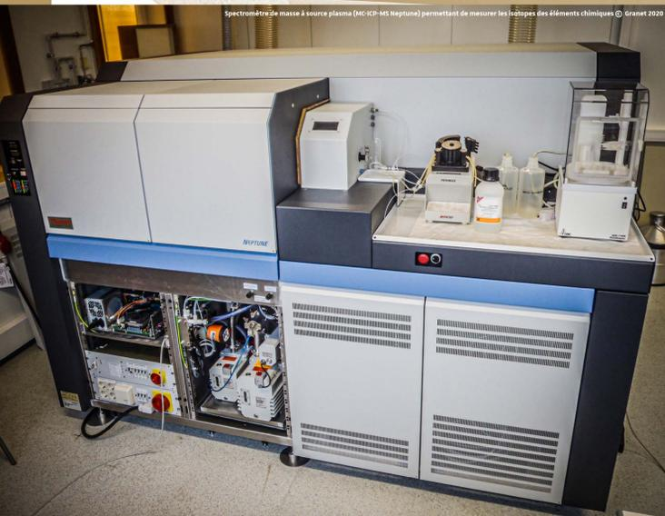
Spectromètre de masse à source plasma (MC-ICP-MS Neptune) permettant de mesurer les isotopes des éléments chimiques © Granet 2020
