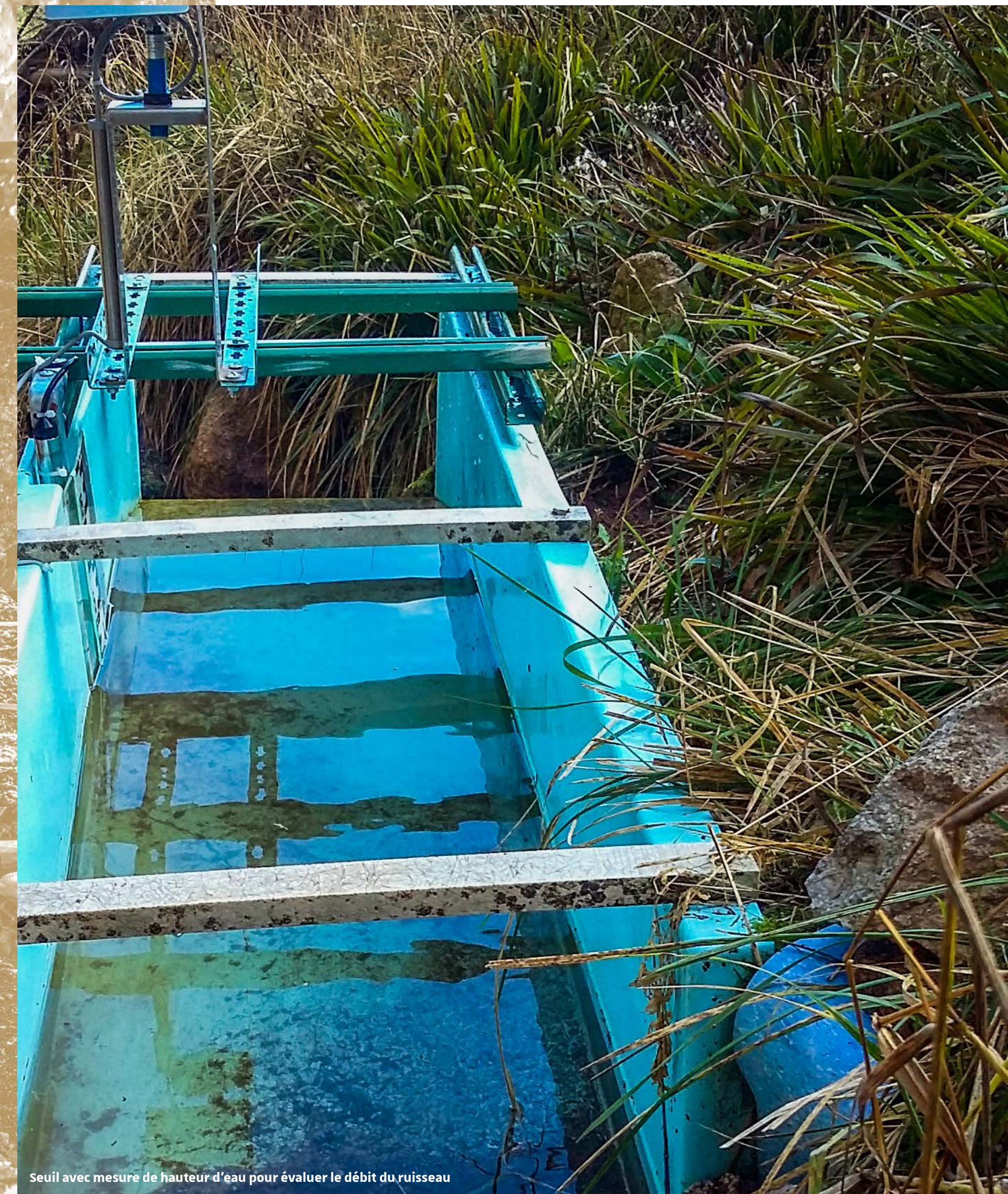
Seuil avec mesure de hauteur d'eau pour évaluer le débit du ruisseau
