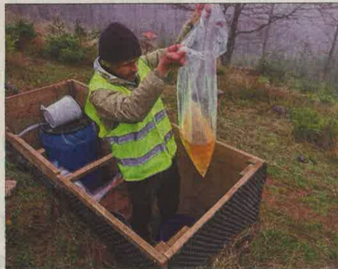
Benjamin Belfort de l'Engées effectue un relevé des eaux pluviales recueillies à 30 cm de profondeur sur le site expérimental du Strengbach à Aubure. Photo L'Alsace/Herve KIELWASSER
